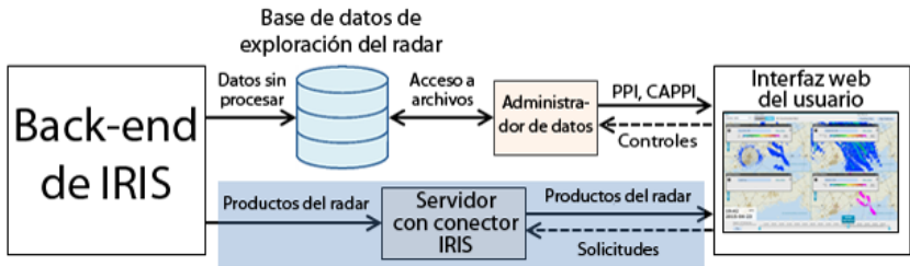
Figura 54 Flujo de datos del producto de IRIS Analysis a IRIS Focus
